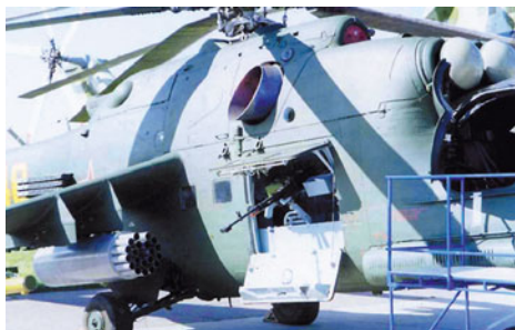
▲ Пулемет «Корд» под патрон 12,7 мм — отличное оружие для оснащения вертолетов. На снимке — ковровский крупнокалиберный пулемет в нише ударно-транспортного вертолета Ми-24.
