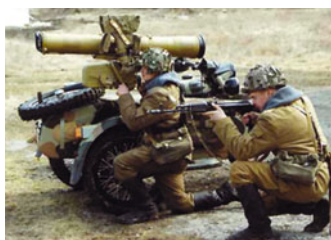
▲ При установке на мотоцикл ПТРК «Конкурс» превращается в очень маневренный самоходный противотанковый комплекс, идеально пригодный для подвижной обороны, ведения разведки и проведения диверсионных операций.
