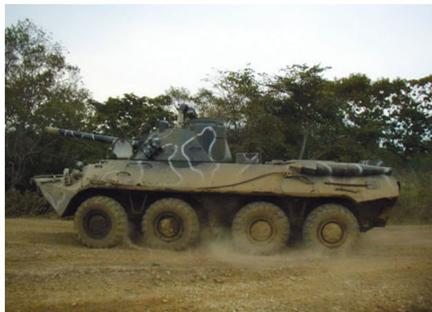
▲ Самоходное орудие 2С23 разработано на шасси бронетранспортера БТР-80.
