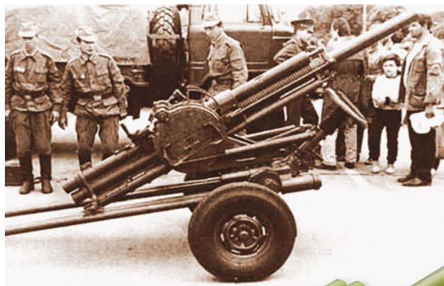
▶ Миномет 2Б9М в походном положении. В качестве тягача используется грузовик ГАЗ-66.
