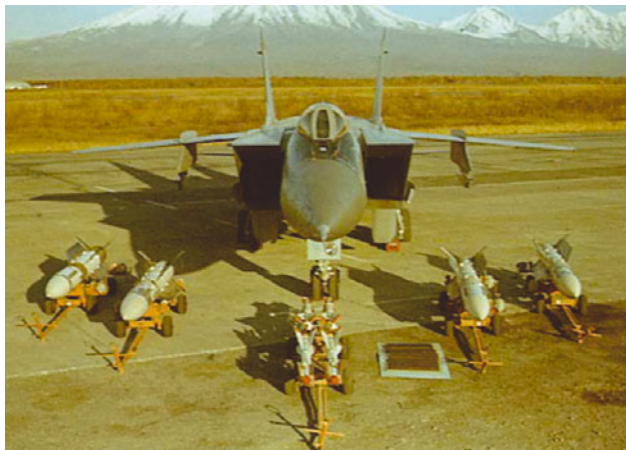
▲ Наряду с 23-мм автоматической пушкой в состав вооружения МиГ-31 входят управляемые ракеты класса «воздух-воздух».
