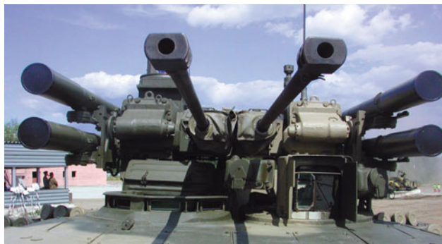
▲ Вооружение БМПТ установлено открыто на небольшой вращающейся башне.
