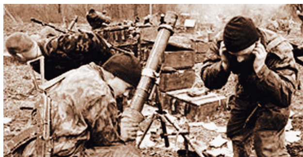
▲ Миномет 2Б14-1 способен вести стрельбу с темпом 28 выстрелов в минуту.
