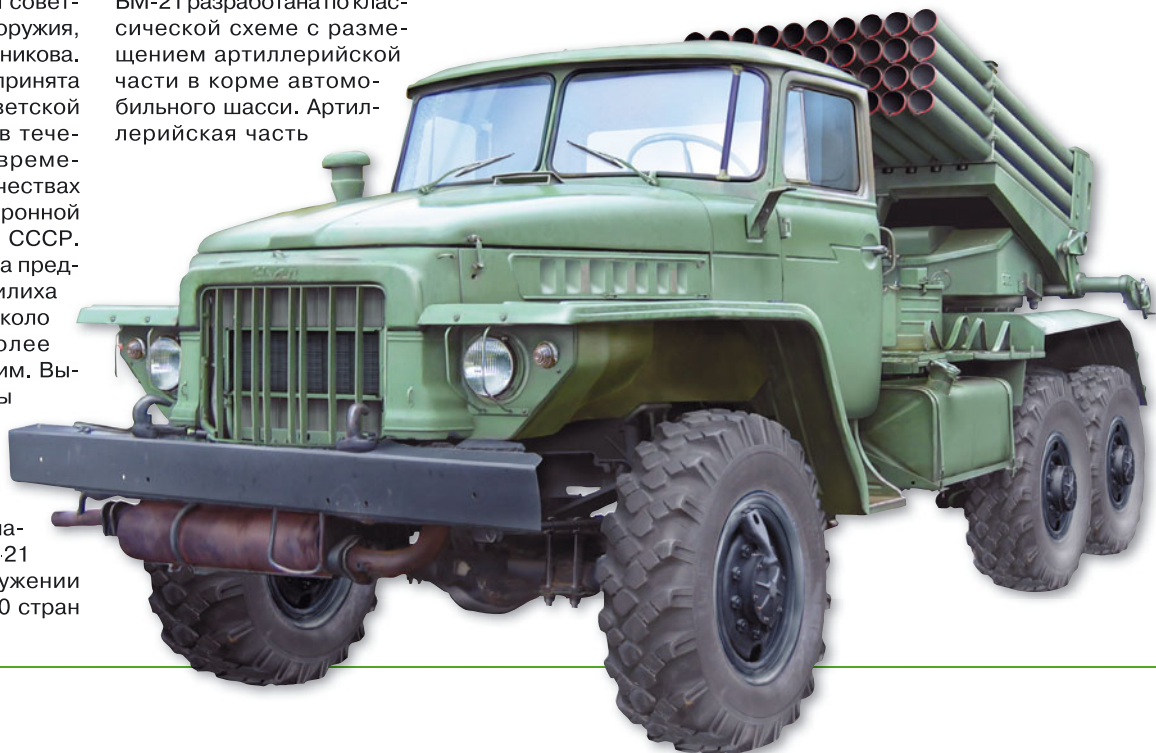
▲ В течение 20 секунд БМ-21 способна выпустить 40 реактивных снарядов.
