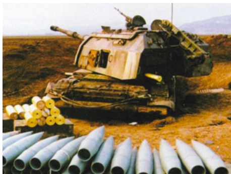
▲ САУ 2С19 «Мста-С» на боевой позиции. Чечня, Вторая чеченская кампания. На земле лежит боекомплект гаубицы: отдельно — метательные заряды в гильзах, отдельно — сами снаряды.
