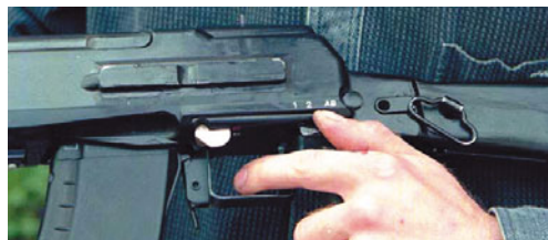
► Переключатель режима огня автомата АН-94, служащий одновременно переключателем предохранителя, имеет весьма удобное для стрелка расположение.
