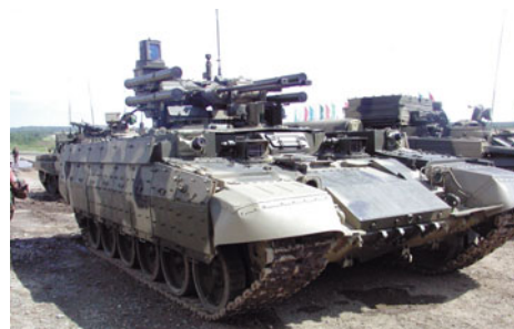
▲ Надежная защита лобовой части корпуса БМПТ обеспечивается комбинированной броней.
