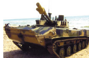
▲ Водные преграды БМД-4 преодолевает впласть со скоростью до 10 км/ч.
