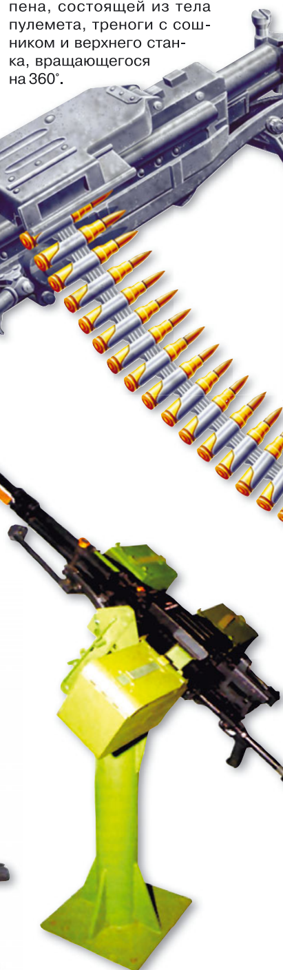
▶ Крупнокалиберный пулемет «Корд» на тумбовой стойке СП. Такая установка, имеющая обозначение 6П150-3, может применяться для вооружения кораблей.
