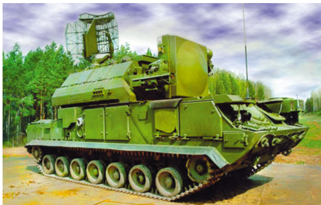
◀ Советский ЗРК 9К330 «Тор» в боевом положении. Пуск ракет производится вертикально с помощью специального газогенератора.
