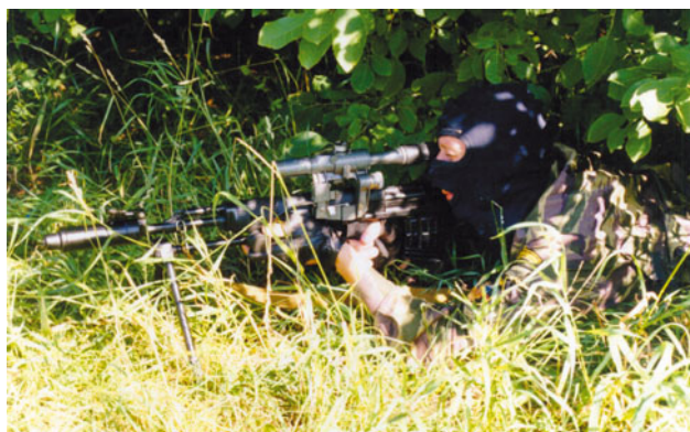
▲ Конструктивная схема «булл-пап», по которой скомпонованы узлы и механизмы винтовки СВУ, обусловила компактность оружия. В настоящее время полностью автоматическая модификация СВУ-АС, оснащенная раскладной двуногой сошкой, принята на вооружение частей внутренних войск и спецподразделений МВД России.
