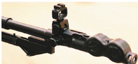
▲ Дульный компенсатор оригинальной конструкции автомата «Абакан» существенно повышает точность стрельбы.
