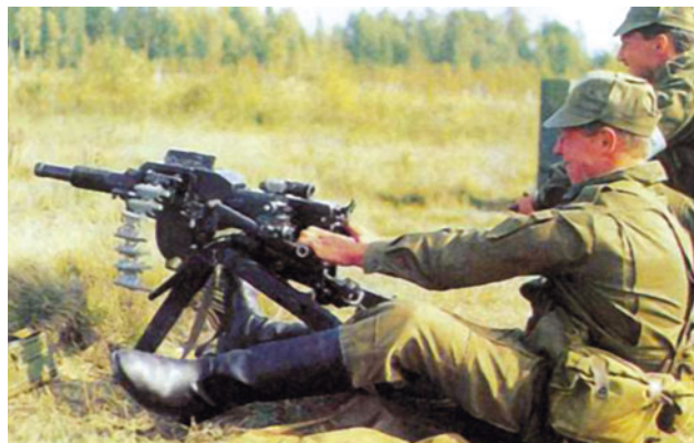
▲ Основным типом боеприпасов к АГС-17 были осколочно-фугасные гранаты. Барабан с лентой гранат размещался справа оружия, пустая лента выходила из приемника налево.
