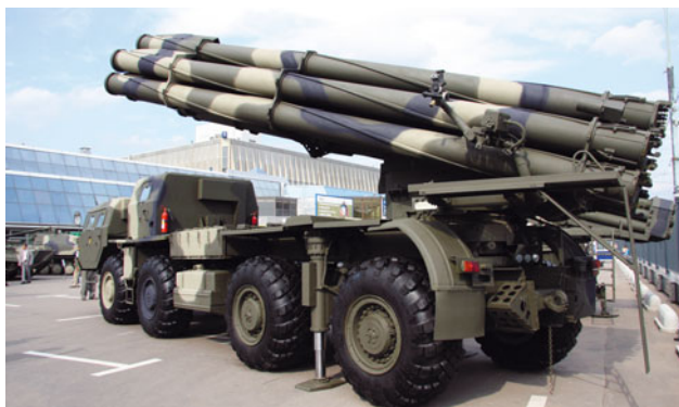
▲ Пакет направляющих может наводиться в вертикальной плоскости в диапазоне углов от 0° до +55°.
