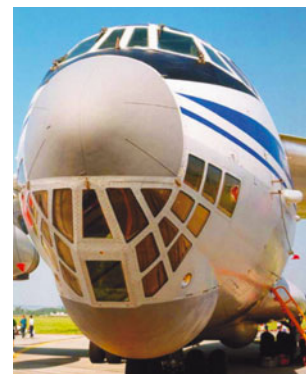
▲ Конфигурация передней части фюзеляжа обеспечивает размещение обзорной антенны РЛС и рабочего места штурмана.
