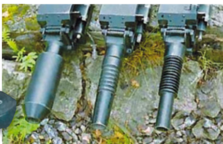
▲ Ствол авиационных гранатометов типа АГС-17 (слева) для лучшего охлаждения оснащался массивной алюминиевой насадкой. Подобная насадка, но значительно меньших размеров имела и на стволе основного образца (в центре). Сначала 1990-х гг. гранатомет выпускается без насадки (справа).
