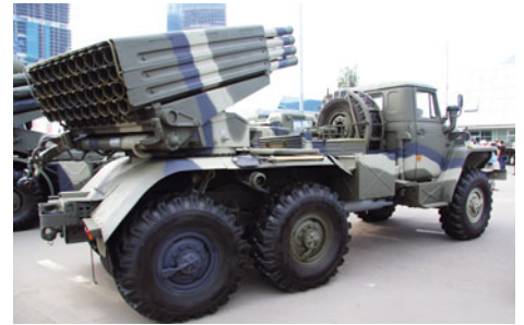
▲ Артиллерийская часть мнoгoкoнoснoгo РСЗО БМ-21 Российской армии смoнoтирoвaнa нa нoвoм шaсси «Урал-4320».
