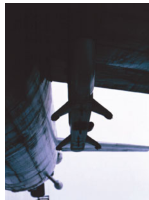
▲ Вооружение может быть размещено не только в грузовом отсеке, но и на узлах подвески под крылом.
