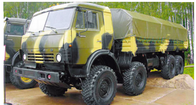
▲ В семейство армейских грузовых автомобилей «Мустанг» входит четырехосный КамАЗ-6350 грузоподъемностью 10 т.
