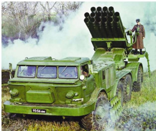
▲ На артиллерийской части установки 9К57 смонтирована площадка для наводчика.
