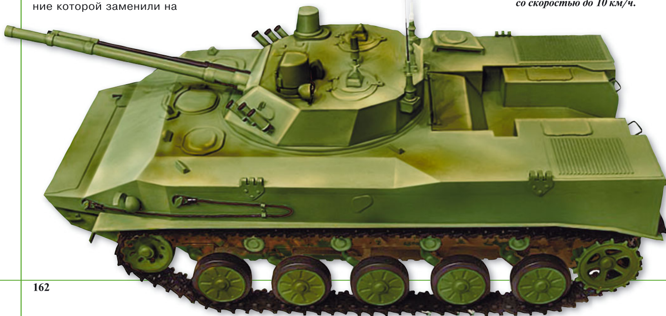
▲ Водные преграды БМД-4 преодолевает впласть со скоростью до 10 км/ч.
