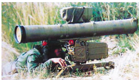
◀ Переносной ПТРК «Конкурс-М» оснащен тандемной боеголовкой и тепловизором, что позволяет с успехом бороться против основных танков противника в любых погодных условиях.
