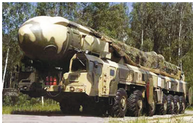
▲ Благодаря использованию многоосного колесного шасси комплекс «Тополь» обладает высокой мобильностью.
