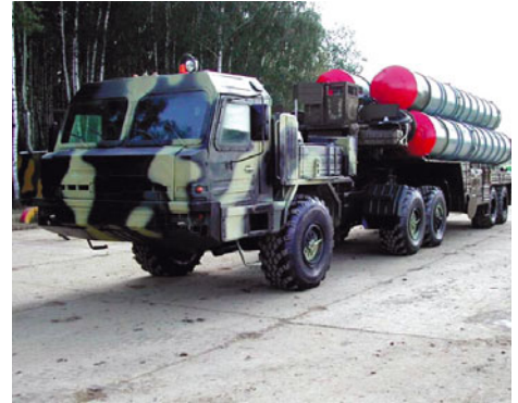
▲ БАЗ-64022 используется в качестве шасси зенитной ракетной системы С-400.
