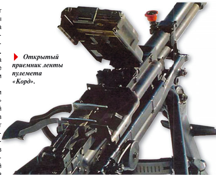
▶ Крупнокалиберный пулемет «Корд» на тумбовой стойке СП. Такая установка, имеющая обозначение 6П150-3, может применяться для вооружения кораблей.
