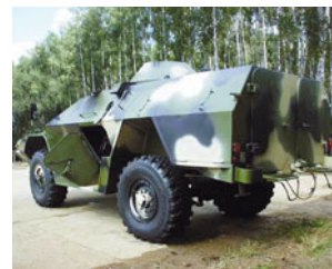
▲ В кормовой части корпуса БПМ-97 сделан люк для посадки и спешивания десанта.
