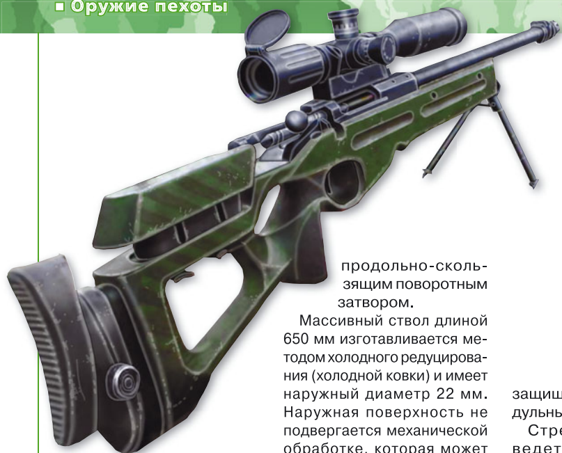
▲ Последние модификации винтовки SV-98 приобрели черты классического современного снайперского оружия. На снимке — открытый затвор винтовки SV-98. Хорошо видна ложа с многочисленными отверстиями в прикладе и рукоятке, делающими винтовку более легкой и удобной в использовании. В качестве прицела установлен прибор ПКС-07 7-кратного увеличения.
