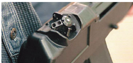
▲ В качестве прицельного устройства в автомате Никонов использовал поворотный прицел необычной конструкции.
