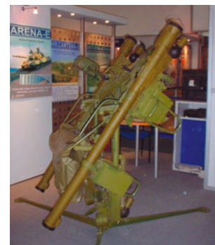
▲ Опорно-пусковая установка «Джигит» состоит из двух пусковых контейнеров с ракетами «Игла» либо «Игла-1».
