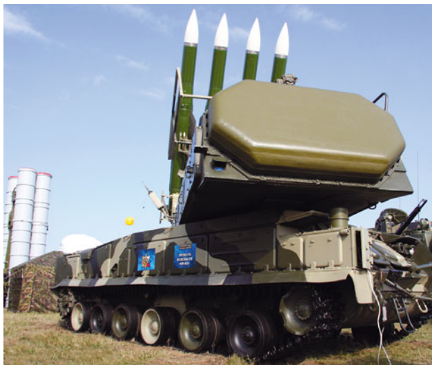
▲ Самоходная огневая установка 9А310 ЗРК 9К37 «Бук». Время ее подготовки к боевой работе после смены позиции не превышает 20 с.
