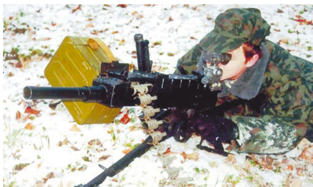
▲ Небольшие размеры, конструкция станка и удобный оптический прицел позволяют с достаточным комфортом вести стрельбу из АГС-30 из положения лежа. И все же при стрельбе очередями из-за тряски оружия плотный контакт стрелка с прицелом может быть небезопасен.
