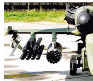
▲ Для размещения вооружения предусмотрены пилоны под крылом самолета.
