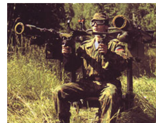
▲ Стрелок-зенитчик комплекса «Джигит» размещается во вращающемся кресле и вручную осуществляет наведение на цель. При стрельбе золотом вероятностное поражение одной цели увеличивается в среднем в 1,5 раза.
