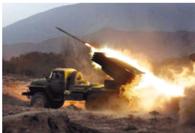
▲ В течение 20 секунд БМ-21 способна выпустить 40 реактивных снарядов.
