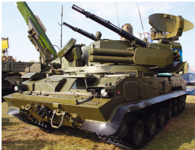
▲ Вооружение комплекса 2К22 состоит из двух 30-мм автоматов и восьми транспортно-пусковых контейнеров ЗУР 9М311.
